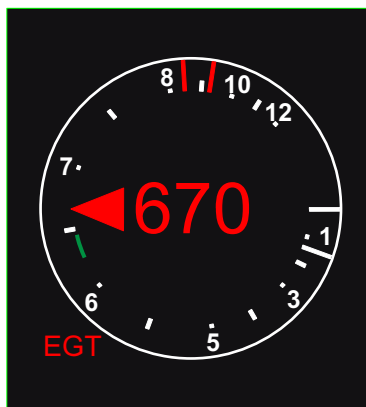
EGT OVERTEMP CAUTION
